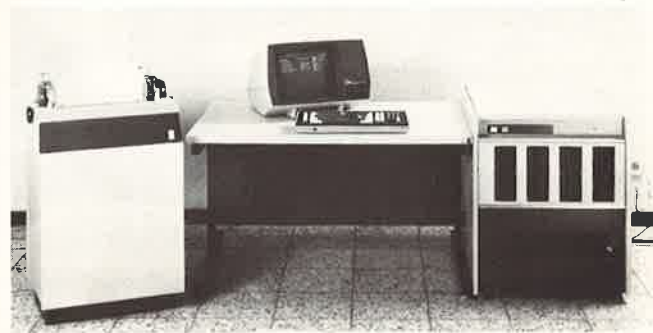
Abb. 3.1.3.4/2: Intelligentes Terminal für formatierte Datenerfassung mit Plausibilitätsprüfung und Statistik sowie Datenfernübertragung, Datenkonvertierung und Drucken
