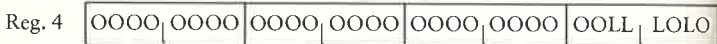
Abb. 2.1.4.3/6: Befehl für eine duale Addition von zwei Registerinhalten in einer Zweiadreßmaschine (Maschinencode)
