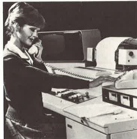
Abb. 3.3.1.1/2: DATEV-Erfassungsterminal mit Bildschirm und Magnetbandkassettenspeicher
