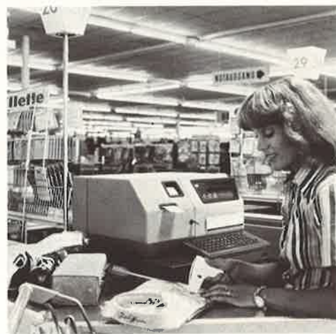
Abb. 3.1.3.1/7: Elektronische Warenkasse mit Lesestift
